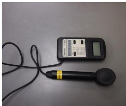
図3 使用した紫外線測定器
