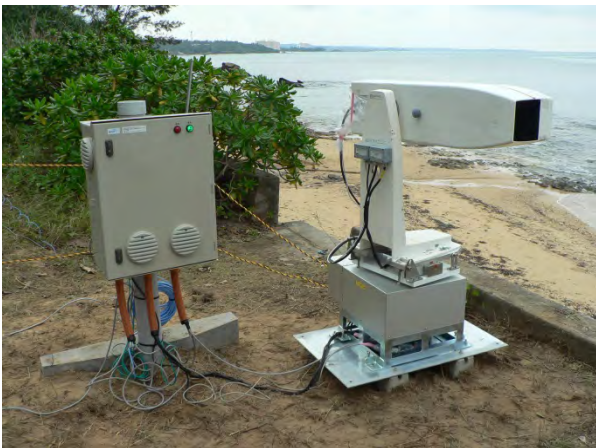
図 3.水平走査シーロメータ回転機構
